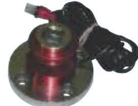
Transductor Smart 0.5% para montaje en banco
